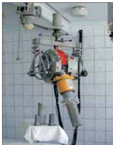
Малогабаритный бетатрон МИБ-6Э с коллиматором 7 × 11 см
